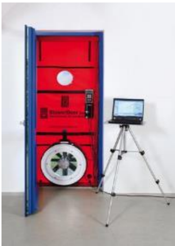
Afbeeldingen: opstelling blowerdoor test + resultaat van de test in grafiekvorm
